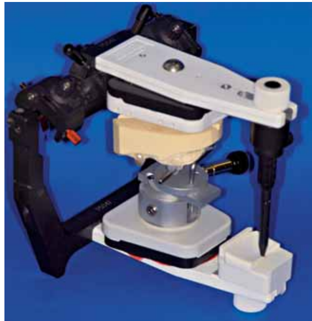
Abb.26 Einbaustativ Ortho 2A mit Modell im Artikulator eingebracht, fertig zum Montieren des Oberkiefermodells.
