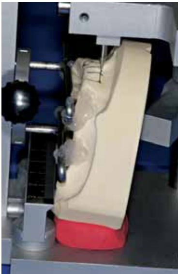
Abb.24 Fixierung des Modells mittels Heissklebstoff auf dem Adapter des Einbaustativs Ortho 2A.
