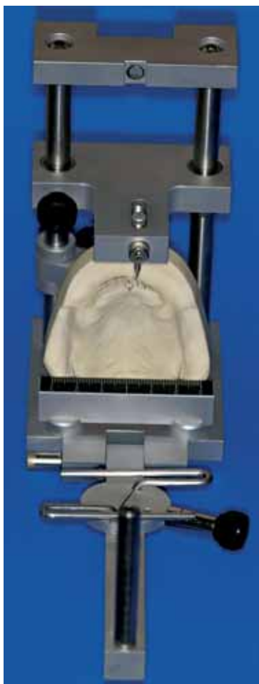
Abb. 21 Fixierung des Oberkiefermodells im Positionierer Ortho 1A mittels Plastilina, Ausrichtung der Medianen am Nullpunkt der Messkala und Positionierung der Messspitze auf die Conclusionslinie.
