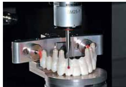
**Abb. 9b** Das Gerüst wird zuerst von basal und sekundär von okklusal mechanisch abgetastet.
